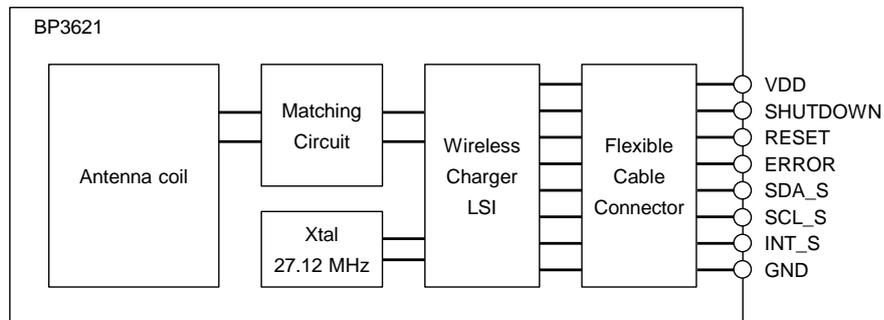
**Figure 1. Block Diagram**
