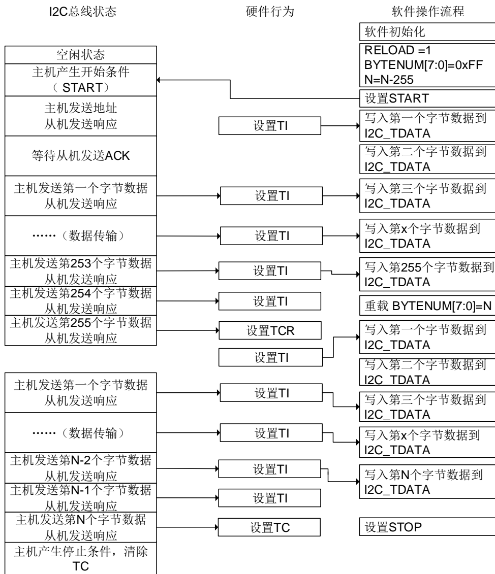
图 21-32. I2C 主机发送编程模型 (N>255)
